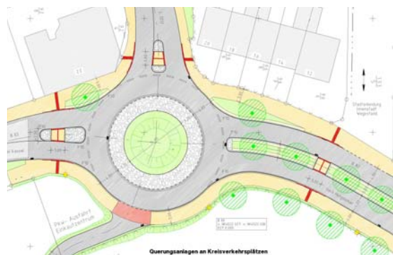
Abb. 1: Kreisverkehrsplatz in Mittelzentren
